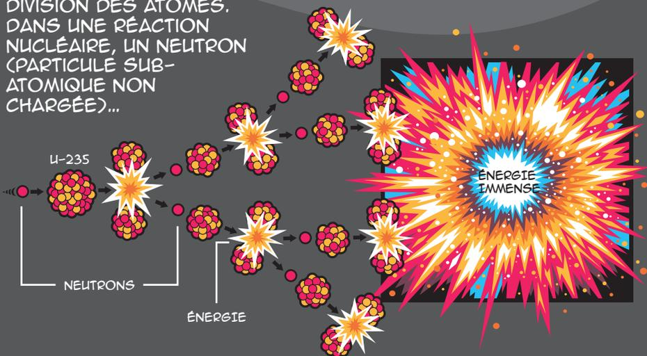
... EST PROJÉTÉ SUR LE NOYAU D'UN ISOTOPE D'URANIUM 235. L'AJOUT DE CE NEUTRON DANS LE NOYAU ALOURDIT L'ISOTOPE ET LE REND TRÈS INSTABLE. POUR LIBÉRER CETTE ÉNERGIE, L'ISOTOPE SE FRACTIONNE ALORS EN DEUX, ET QUELQUES NEUTRONS S'EN DÉTACHENT. C'EST EUX QUI IRONT FRAPPER LES AUTRES ISOTOPES D'URANIUM 235, CE QUI ENTRAÎNERA UNE RÉACTION EN CHAÎNE. C.-À-D. UNE RÉACTION NUCLÉAIRE.
