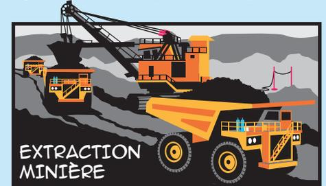
L'EXTRACTION MINIÈRE EST PRÉCONISÉE QUAND LES SABLES BITUMINEUX SONT ASSEZ PRÈS DE LA SURFACE POUR ÊTRE RÉCUPÉRÉS PAR DES EXCAVATEURS, PUIS CHARGÉS DANS DE GROS CAMIONS. LES SABLES BITUMINEUX SONT TRANSPORTÉS VERS UNE USINE ET MÉLANGÉS AVEC DE L'EAU CHAUDE POUR SÉPARER LE SABLE ET L'ARGILE.
